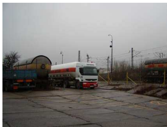
Obr. č.42: Přečerpávání LPG z železniční cisterny
