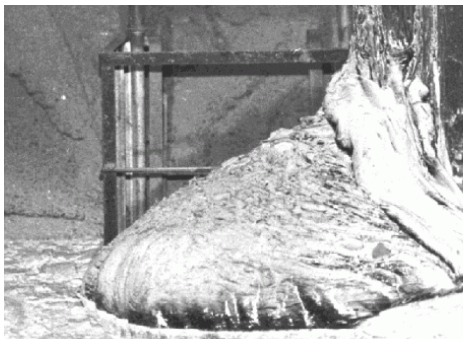
Obr. č. 4: Jeden z roztavených zbytků radioaktivního paliva uvnitř zničeného reaktoru, který má pro svůj zvláštní tvar název Sloní noha (49)
