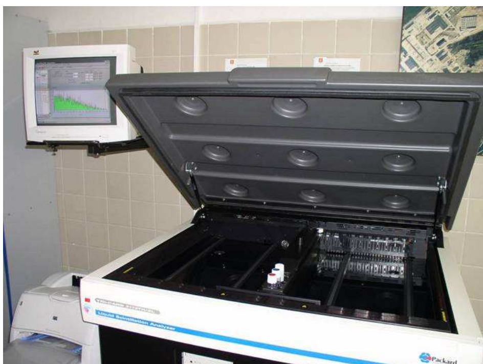
Obr. A.2 Kapalinový scintilační spektrometr Tricarb 3170 TR/SL používaný pro měření aktivit ^{14}\text{C} ve zpracovaných vzorcích.
