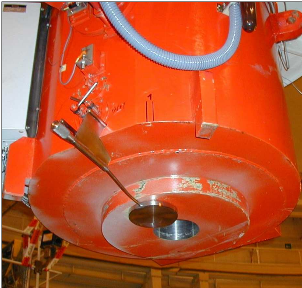
Obr. 4.13 Pohled na nezakrytý vstupní otvor navíjedla MNT s instalovanou clonou, kterou je tento otvor během transportu uzavírán.
