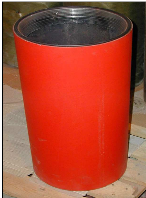
Obr. 4.15 Stínící patrona ve které jsou čidla MNT ukládána na úložiště VRAO.
