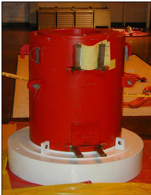
Obr. 4.14 Stínící kontejner sloužící k transportu vyjmutých čidel na úložiště VRAO.
