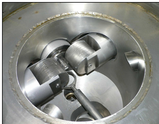
Obr. 4.10 Vnitřní část navíjedla sloužící k zachycení a navinutí čidla. MNT.
