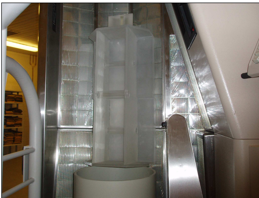
Obr 4.18 Fantom lidského těla uvnitř měřicího prostoru PCM-2.
