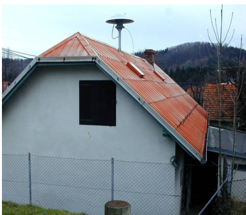
Obrázek 13: Rotační siréna DS 977. [8]
