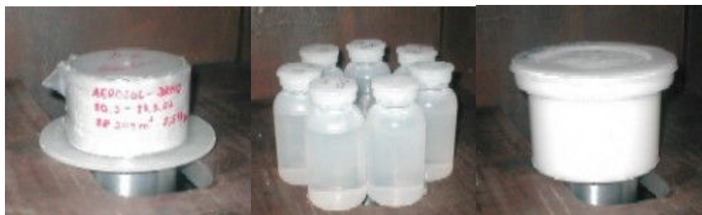
Obr. 14. Použité geometrie měření, zleva F1, L1 a MA.
