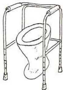
Obr. 27 Zábradlí na WC
