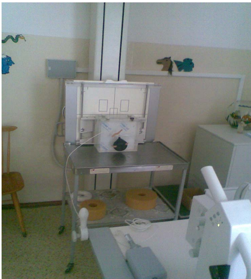
Obrázek 11: Měření vstupní povrchové dávky na přístroji FOMEI HF 50R
