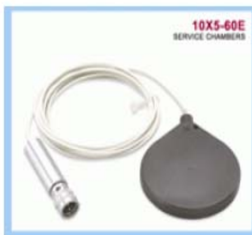
Obr.7: Ionizační komora o objemu 60 cm 3
