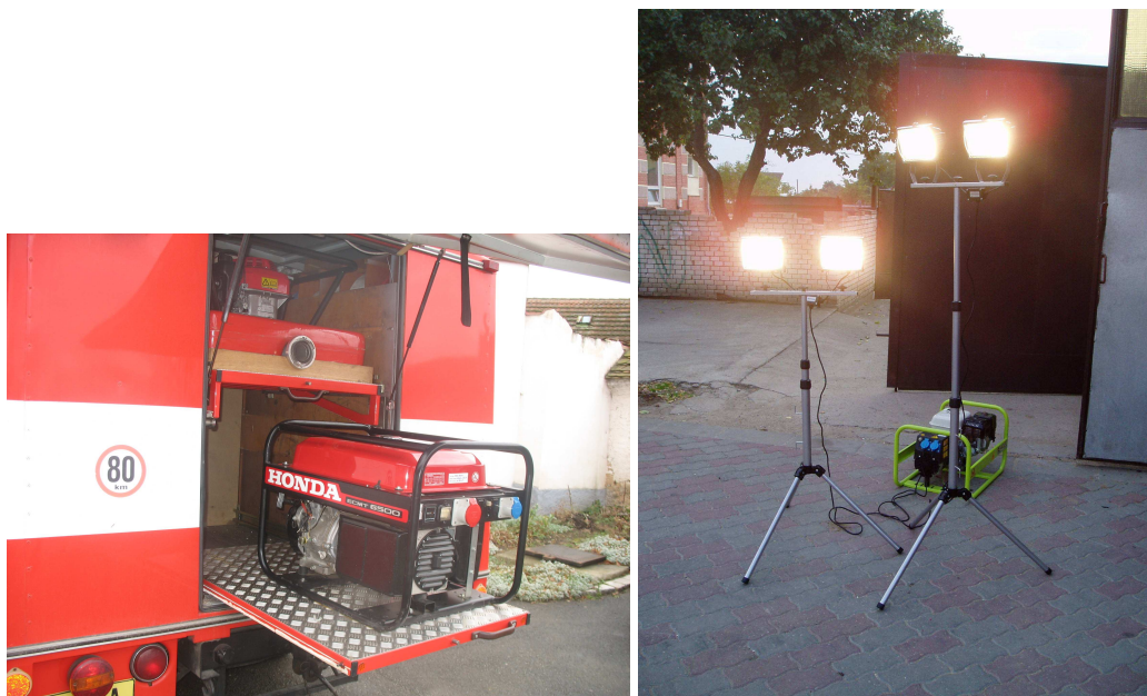
Obr. 13 Elektrocentrála typu HONDA a zapojená osvětlovací technika
