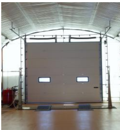
Obr. 22 Dekontaminační rám pro mobilní techniku
