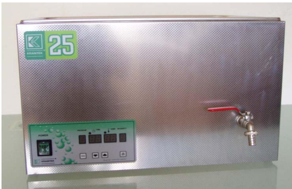
Příloha č. 2 Ultrazvuková lázeň Kraitex 25 KE
