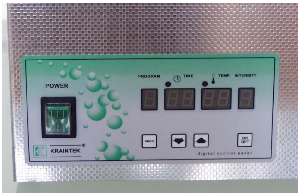
Příloha č. 3 Digitální regulace ultrazvukové lázně
