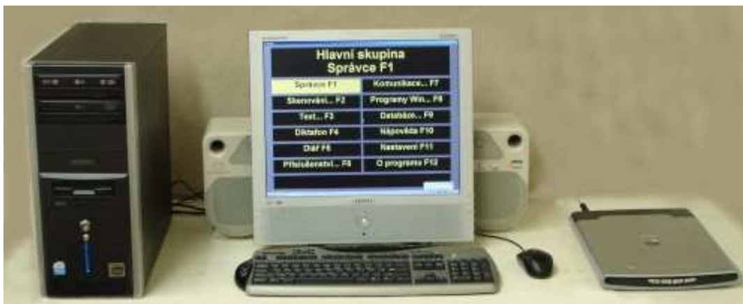
Obrázek číslo 3 Osobní počítač představující čtecí přístroj s hlasovým výstupem
