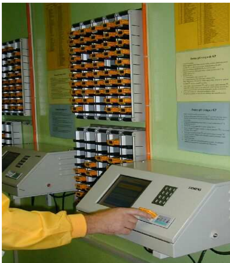
Obr. 1.2.5: Terminál systému elektronické osobní dozimetrie na JE Temelín.
