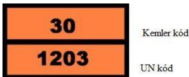
Obr. 1.3 bezpečnostní značka (motorová nafta)
