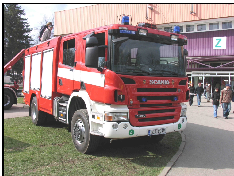
Cisternová automobilová stříkačka CAS 24 Scania, jedná se o „prvovýjezdové vozidlo“ s osádkou 1+5
