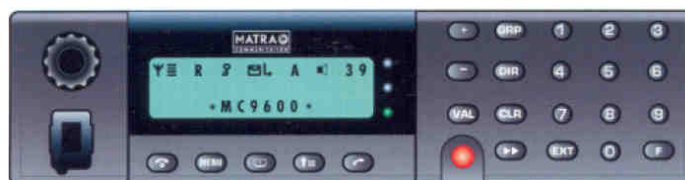
vozidlová radiostanice Matra Pegas, typ MC 9610 SMART
