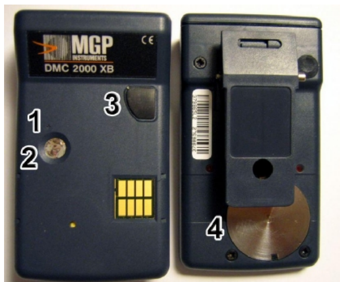
Obrázek č. 1-10: Elektronický osobní dozimetr DMC 2000 XB, vyráběný firmou MGP Instruments SA ( 1 – střed detektoru, 2 – vstupní okénko pro detekci záření beta, 3 – funkční tlačítko, 4 – kryt baterie ).
