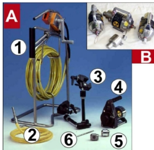
Obrázek č. 1-15: Gama defektoskopie (A: 1 – dálkové ovládání, 2 – výjezdová hadice, 3 – stojan, 4 – izotopový kryt se zdrojem IZ, 5 – kolimátory, 6 – výjezdová špička. B: Gammamat TI se ZIZ).
