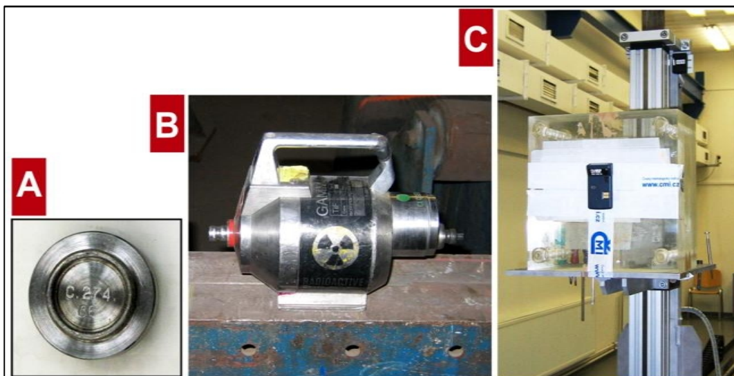
Obrázek č. 3-4: Měření odezvy ED DMC 2000 XB k záření beta a gama v ČMI - IIZ. ( A: zářič ^{90}\text{Sr}/^{90}\text{Y} , B: zářič ^{192}\text{Ir} a ^{75}\text{Se} , C: elektronický dozimetr DMC 2000 XB umístěný na fantomu PMMA 30x30x15 cm 3 )
