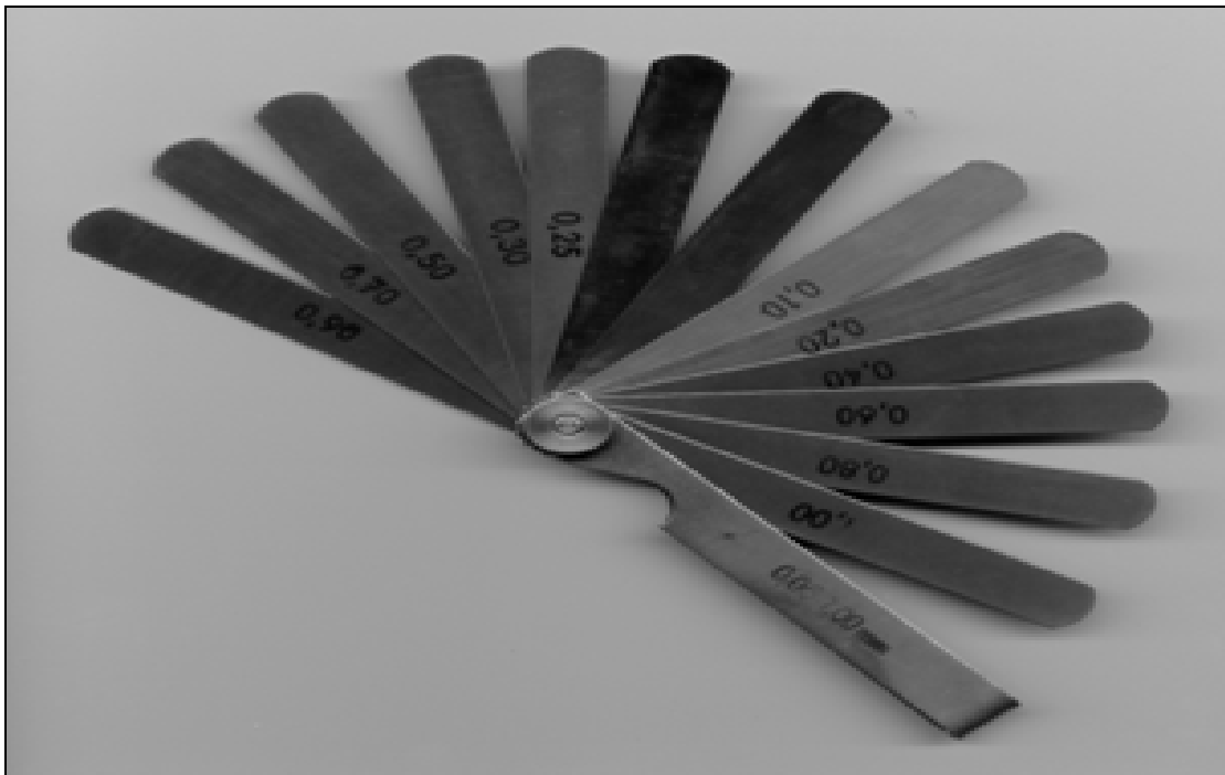
Obr. 14: Pomůcka pro měření štěrbin protilehlých lamel
