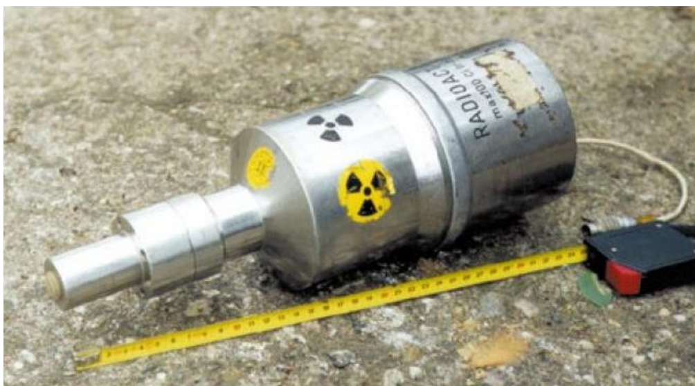
Příloha č. 5: Defektoskop M18, zářič ^{192}\text{Ir} o aktivitě max. 3,7\text{TBq} , uranové stínění
