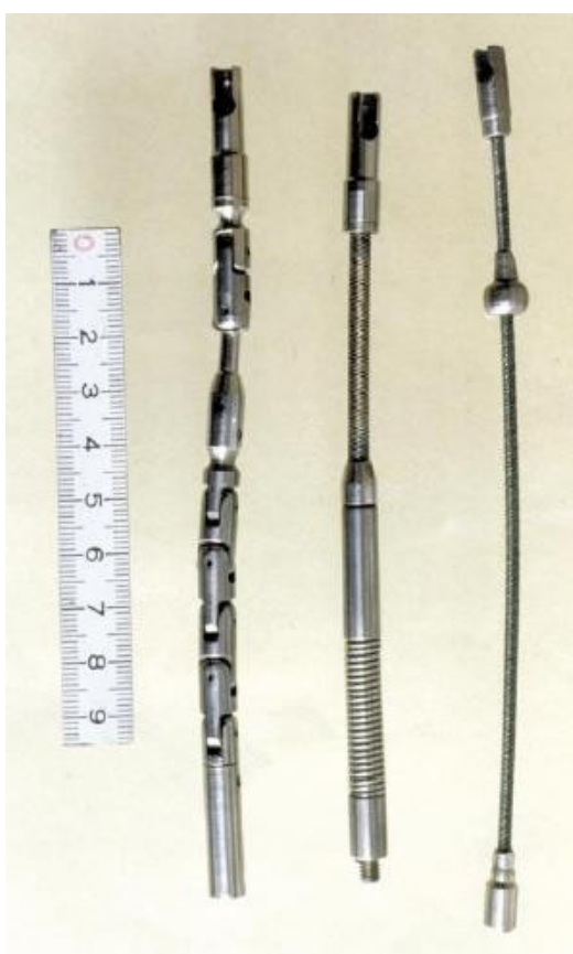
Příloha č. 6: Držáky na zářiče používané v defektoskopech k ovládání polohy zářiče.
