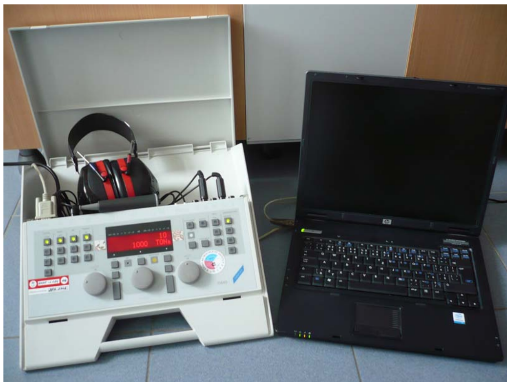
Sestava audiometru typu DANPLEX 65 s přenosným počítačem použita k měření tónovou audiometrií
