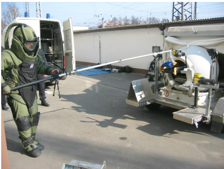
Příloha č. 3 - manipulační tyč pro odstupnou manipulaci (s délkou kolem 3 metrů)
