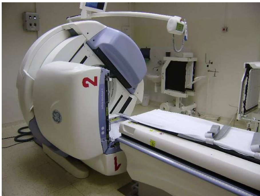
Poloha detektorů při měření homogenity zorného pole u detektoru č. 2
