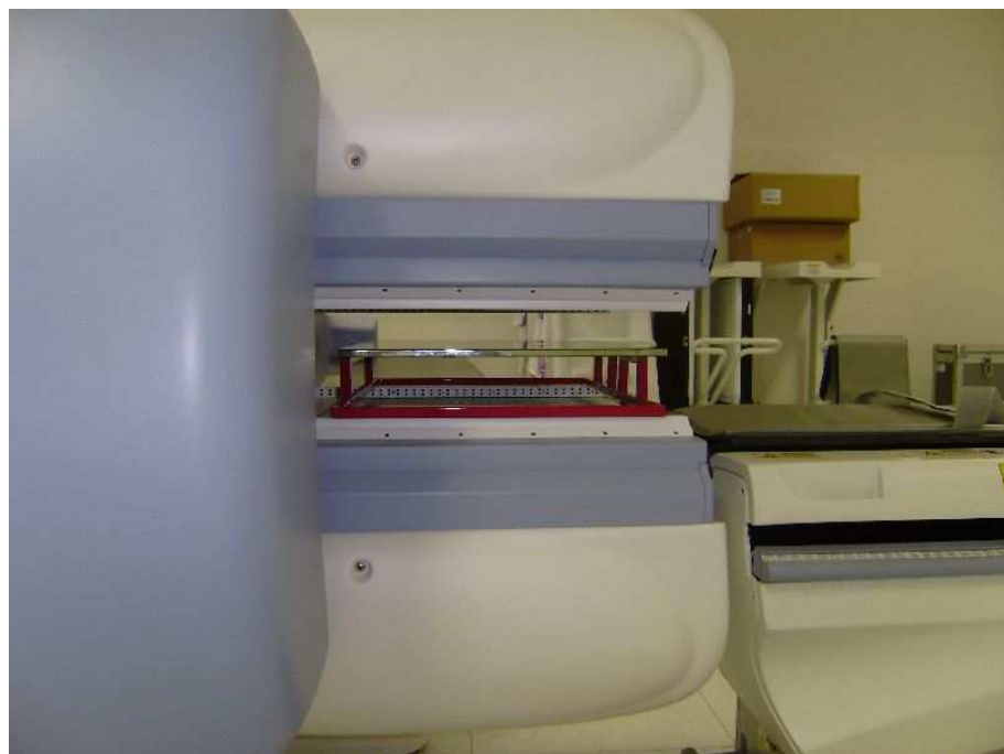
Detektory v horizontální poloze a nainstalovaný plošný zdroj – detail z boku
