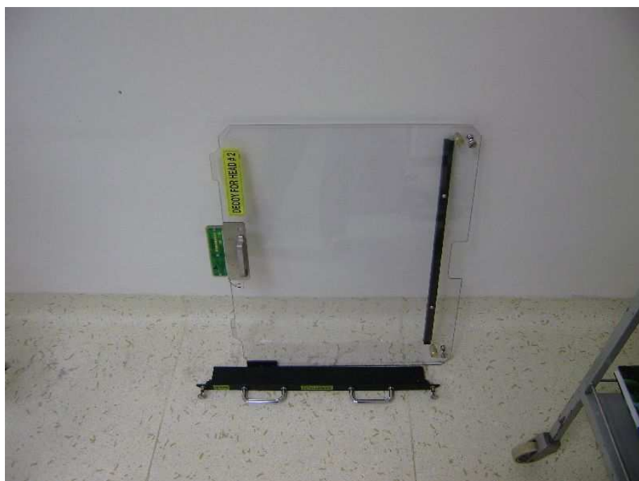
Kolimátor typu DECOY – po nainstalování plní funkci krytu krystalu detektoru
