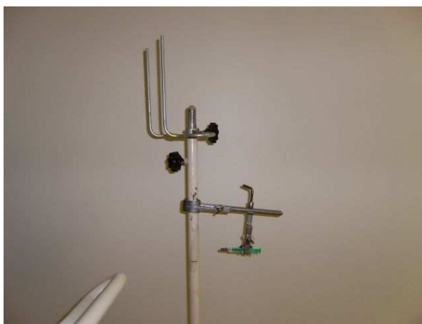
Obrázek č. 11: Detail bodového zdroje – stříkačka s obsahem 1 ml ^{99m}\text{Tc} uchycená ve stojanu
