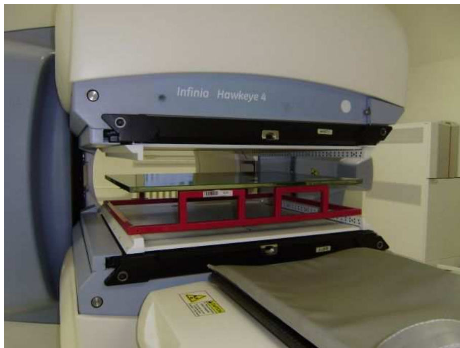
Obrázek č. 13: Detektory v horizontální poloze 180° s nainstalovaným plošným zdrojem (IKEM Praha)
