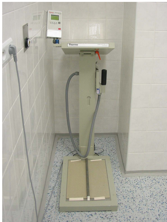
Obr. 4 Radiometr pro kontrolu vnitřní kontaminace pracovníků
