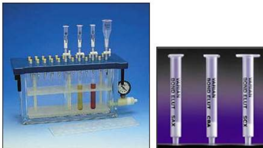
Obr. 3.2: Zařízení pro provádění SPE a detail kolonek. (45, 46)
