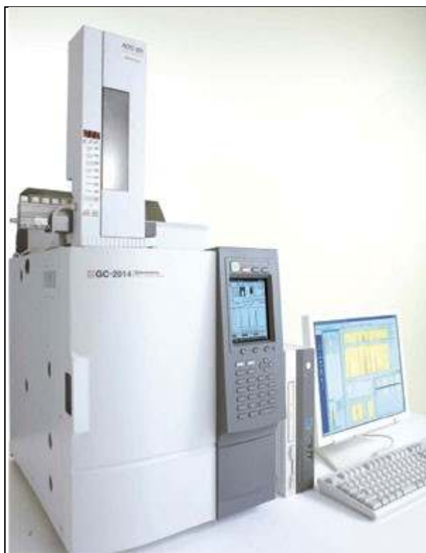
Obr. 3.5: Přístrojové zařízení - chromatograf Shimadzu GC-2014. (47)
