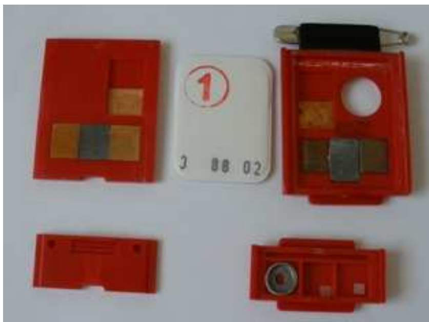
Obr. 2. nahoře - Filmový dozimetr s filtry a bakelitovým obalem, dole - příchytá kazetka s TLD
