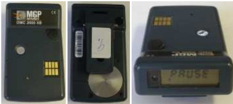
Obr. 10. DMC 2000 XB, pohled zepředu: dozimetr je opatřen detektorem, vstupním okénkem pro detekci IZ, funkčním tlačítkem, pohled zezadu: přichytný klip, kryt baterie, pohled ze shora: funkční displej
