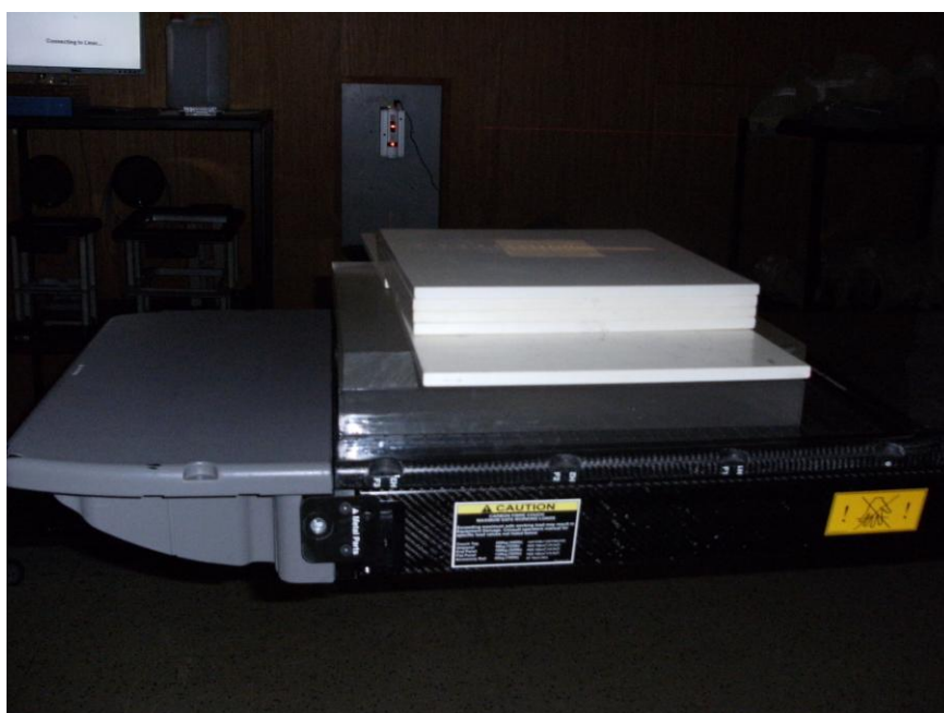
Obrázek č. 17 – Jiný pohled na schéma uspořádání vzorků a pomocných desek z PVC při ozařování na stole lineárního urychlovače
