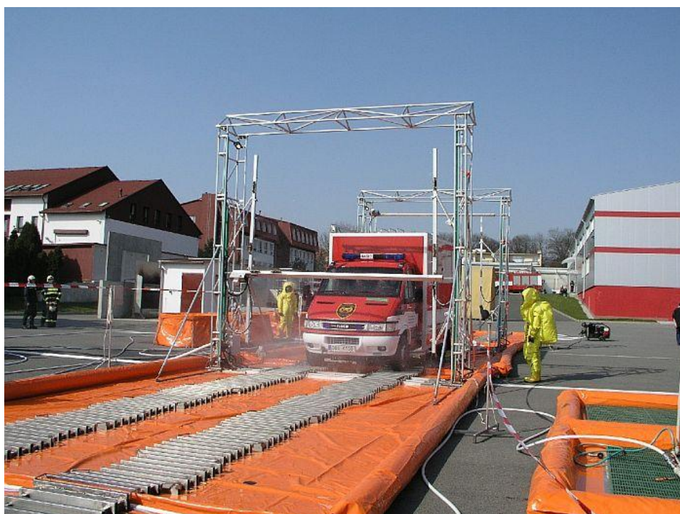
Stanoviště dekontaminace techniky
