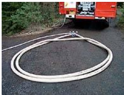
Obr.č.3 - Ukázka vytvoření nouzové záchytné vany
