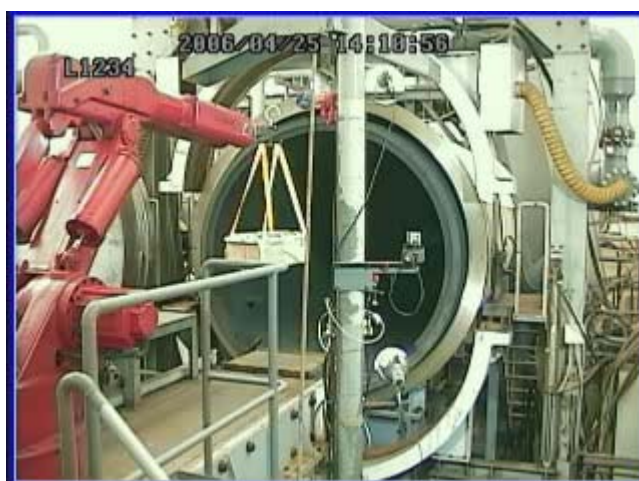
Obrázek č. 8. Zařízení DAVINCH™ pro likvidaci munice v přístavu Kanda – zavážení munice
