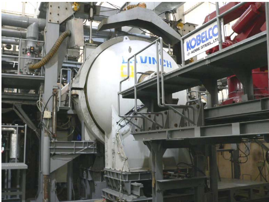
Obrázek č. 7. Zařízení DAVINCH™ pro likvidaci munice v přístavu Kanda – celkový pohled
