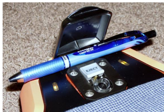
Obrázek 16: Krytí přístroje a aretace víka vialkového prostoru
