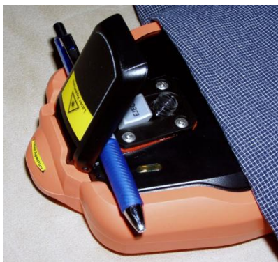
Obrázek 12: Krytí přístroje a aretace víka vialkového prostoru
