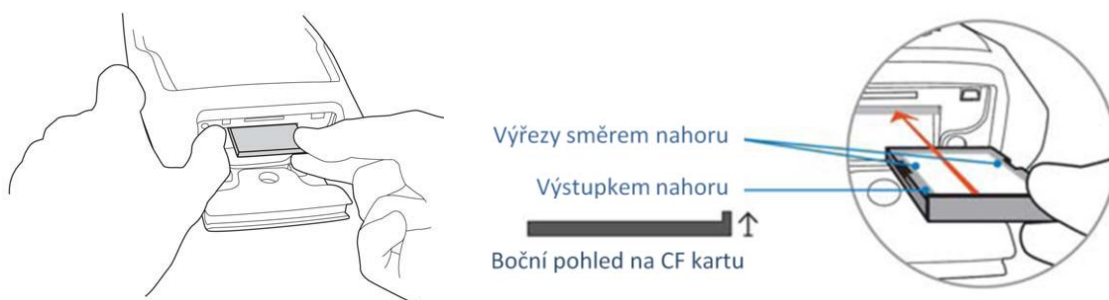
Obrázek 14: Vložení CF karty do přístroje
