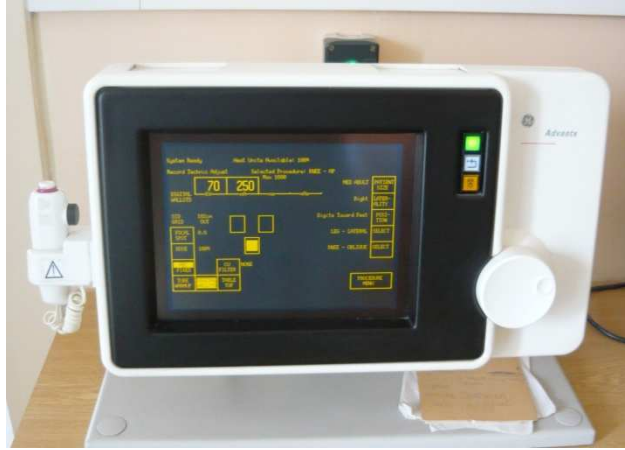
Obr. 2. Příklad přístroje GE Revolution XD s ovládacím touch panelem
