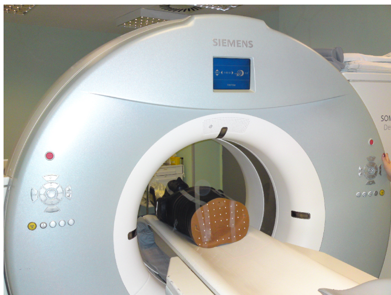
Obr.5 Fantom při vyšetření pomocí CT
