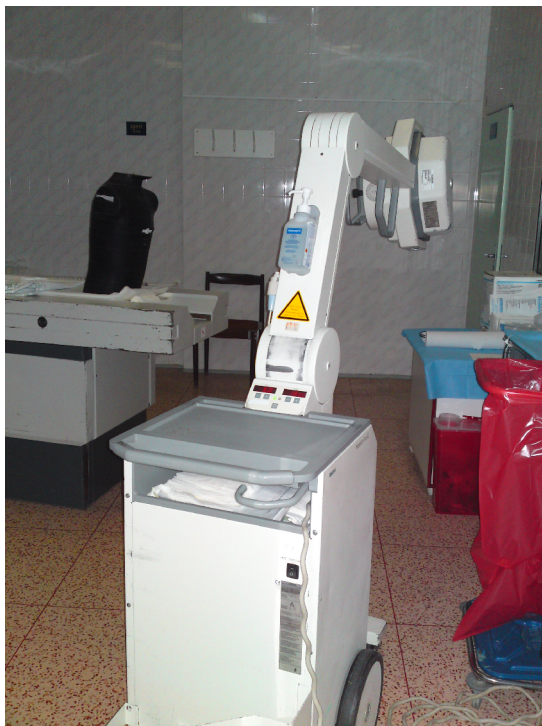
Obr. 3 Snímkování fantomu pomocí pojízdného rentgenu
