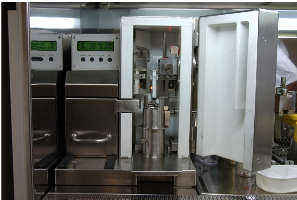
Obrázek č. 4 Stíněný dávkovač se zabudovaným měřičem aktivity
