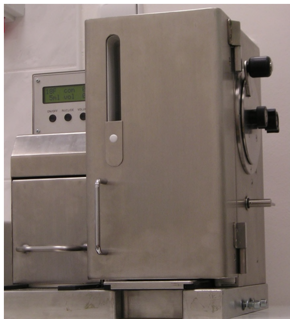
Obrázek č. 5 Stíněný dávkovač se zabudovaným měřičem aktivity
