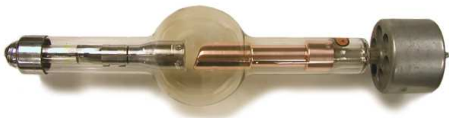
Obr. 38 - Rentgenka americké firmy Westinghouse z počátku 30. let (rozměry: délka 35 cm, průměr baňky 9 cm). (19)
