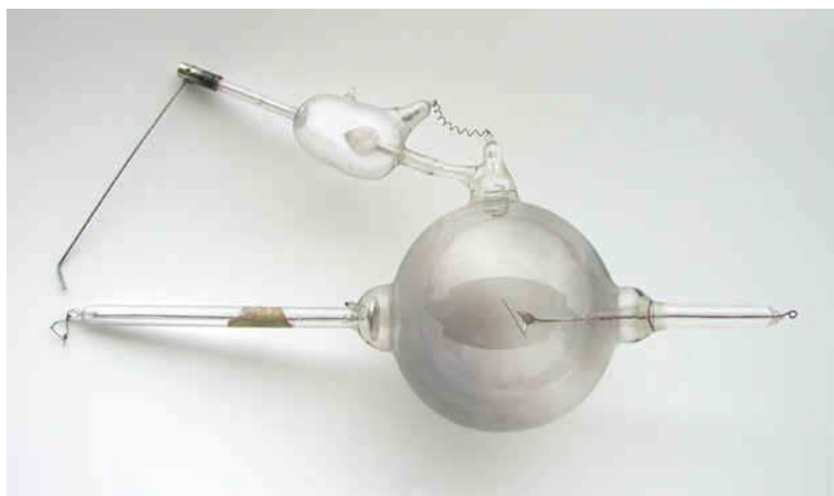
Obr. 13 - Rentgenka Queen & Co. se samoregulátorem.
