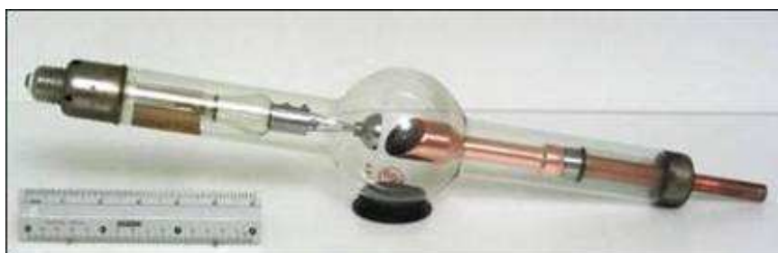
Obr. 36 - Rentgenka německé produkce ze začátku 20. let (rozměry: délka 50 cm, průměr baňky 10 cm). (20)
