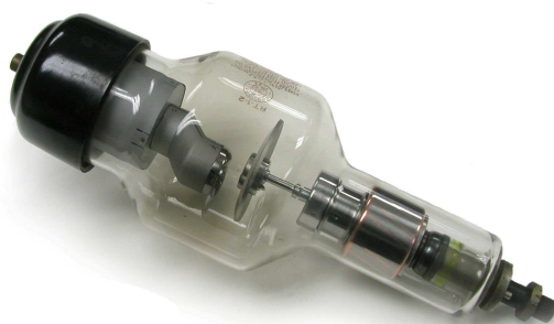
Obr. 41 - Rentgenka s rotační anodou General Electric cca z roku 1940. Rentgenka měla navíc dvojitě ohnisko a dvojitě žhavicí vlákno katody (rozměry: délka 35 cm, max. průměr 12 cm). (19)
