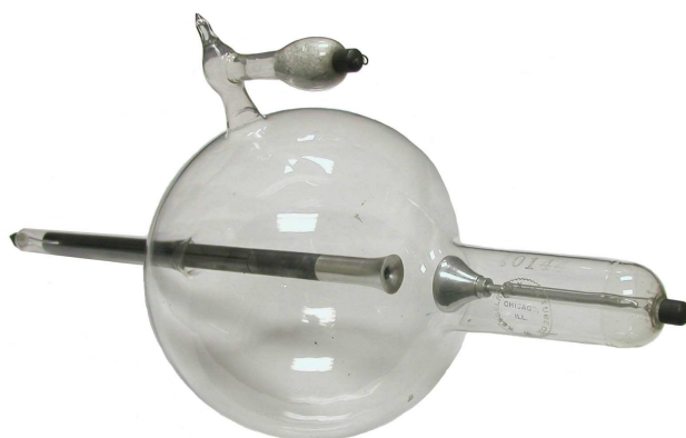
Obr. 17 - Kesselringova rentgenka (rozměry: délka 60 cm, průměr baňky 18 cm).
