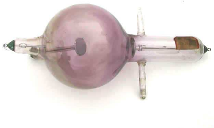
Obr. 12 – Rentgenka německého výrobce Gundelach.
