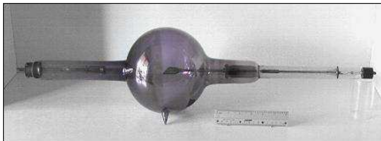
Obr. 29 - Terapeutická rentgenka německé firmy AEG z roku 1915 (rozměry: délka 80 cm, průměr baňky 18 cm).
