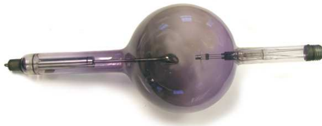
Obr. 30 - Univerzální rentgenka cca z roku 1920 vyráběná americkou společností General Electric (rozměry: délka 50 cm, průměr baňky: 18 cm). (19)
