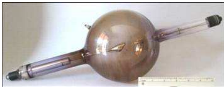
Obr. 28 - Jedna z prvních Coolidgeových rentgenek z roku 1915 vyráběná americkou společností Victor Co. (rozměry: délka 50 cm, průměr baňky 15 cm). (20)
