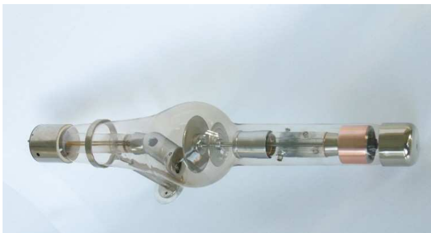
Obr. 40 - Rentgenka s rotační anodou Siemens Pantix z roku 1933 (rozměry: délka 60 cm, max. průměr 12 cm). (27)
