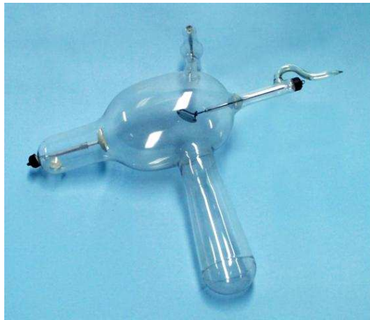
Obr. 19 – Terapeutická rentgenka londýnské firmy Newton & Co.
