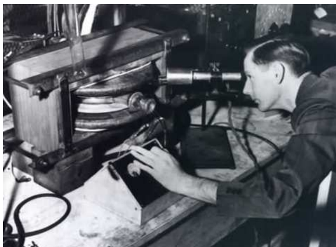
Obr. 60 - Donald Kerst při experimentech s jeho prvním 2,3 MeV betatronem (Urbana, Illinois, USA, 1940).
