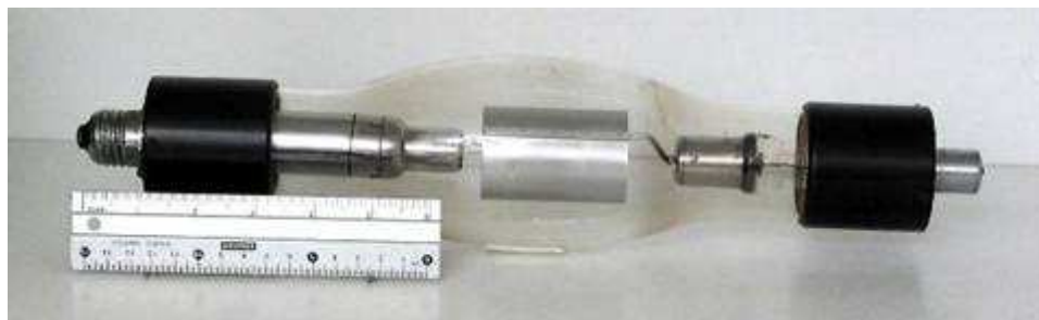
Obr. 42 - Jednosměrný ventil neznámého výrobce cca z konce 20. let (rozměry: délka 35 cm, max. průměr oválu 9 cm).
