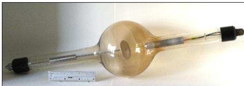
Obr. 32 - Zajímavá konstrukce coolidgeovské terapeutické rentgenky pochází z konce 20. let. Velká a plochá anoda z wolframu je pod úhlem 30°, oproti klasickým 45° (rozměry: délka 80 cm, průměr baňky: 20 cm).
