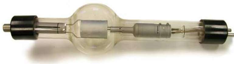
Obr. 46 - První sériově vyráběný kenotron General Electric (rozměry: délka 50 cm, průměr baňky 13 cm). (19)
