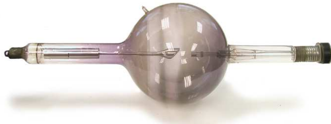
Obr. 31 - Další rentgenka společnosti Victor X-Ray Co. přibližně z roku 1923 (rozměry: délka 50 cm, průměr baňky: 16 cm).
