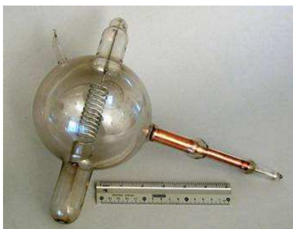
Obr. 43 - Ventil z počátku 20. století navržený angličanem Oliverem J. Lodgem (1851 - 1940). (20)
