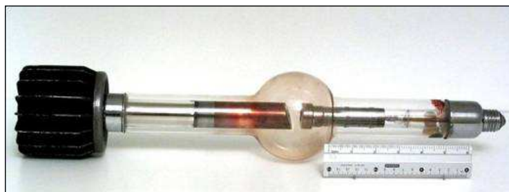
Obr. 39 - Rentgenka francouzské firmy Varay z období II. světové války (rozměry: délka 50 cm, průměr baňky 10 cm). (20)
