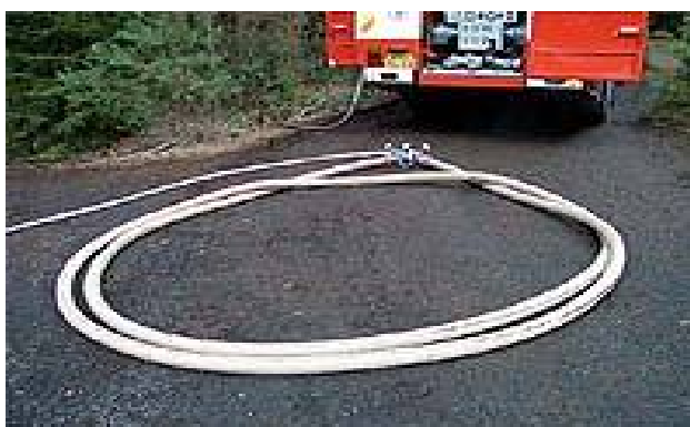
Obr. 5 Stavba jednoduché dekontaminační vany
