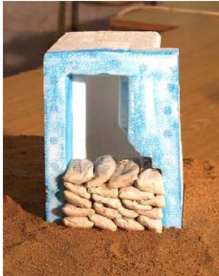
Obrázek č. 7: Částečné utěsnění dveří (15)
