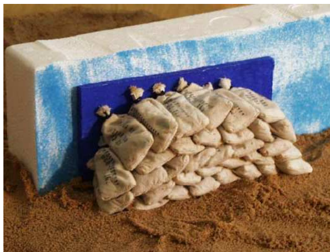
Obrázek č. 10: Příložné těsnění s deskou (15)
