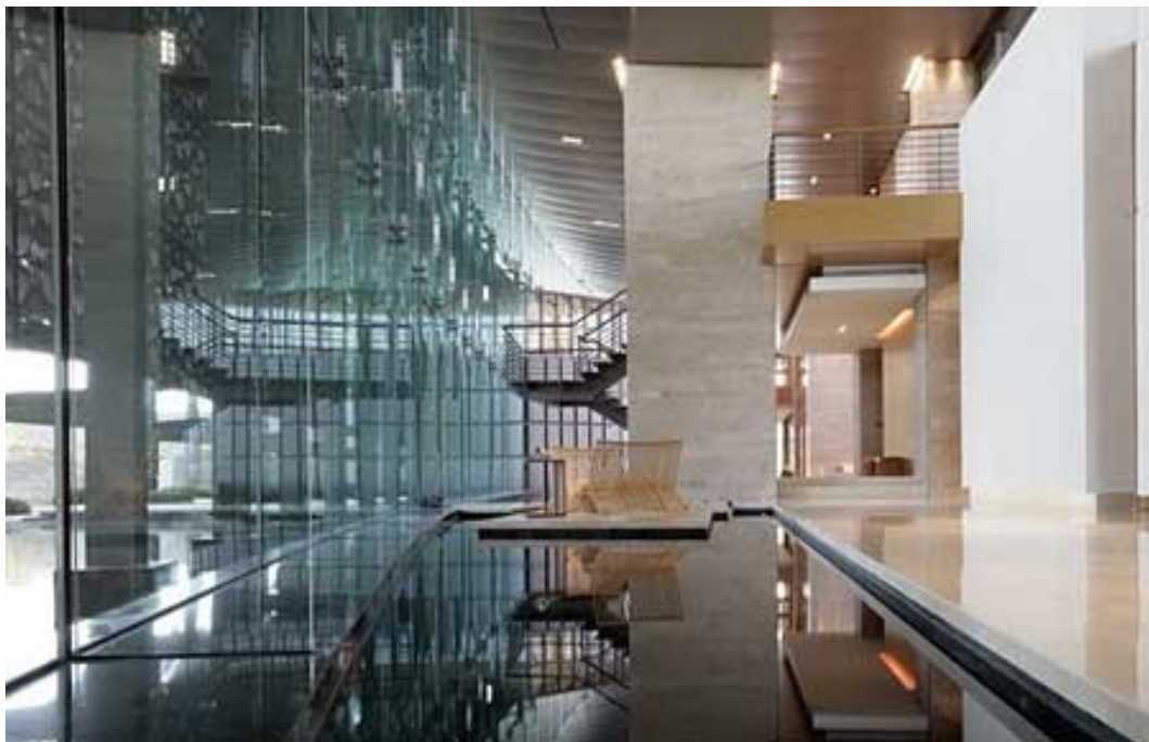
System vnitřních bazénů ochlazuje vzduch v interiéru
