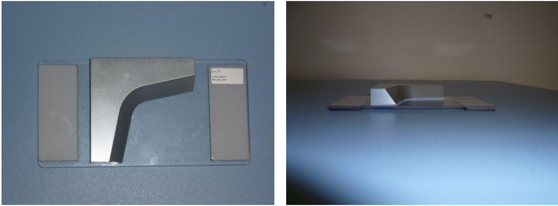
Obr. 29: Fotografie vyrovnávacího filtru pro účel snímkování ramenního kloubu tloušťky 1,5cm
