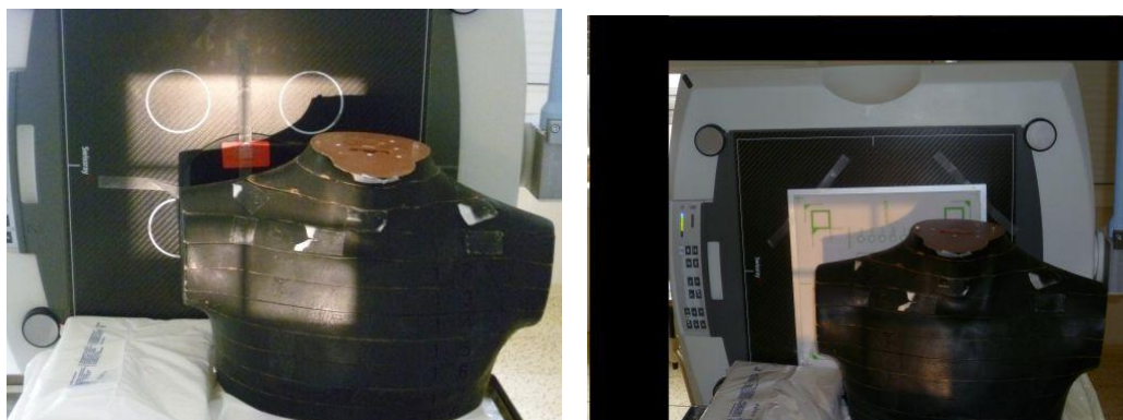
Obr. 36: Fotografie zachycuje způsob měření při použití antropomorfního fantomu s pomůckou DIGI-13
