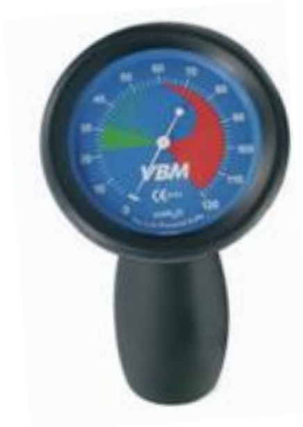
Obr. 17 Manometr na měření tlaku v těsnící manžetě
