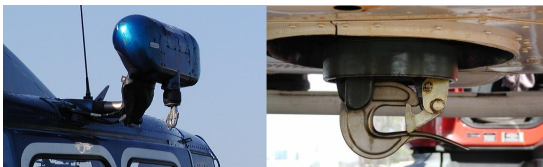
Palubní jeřáb a podvěsný hák vrtulníku Bell 412
