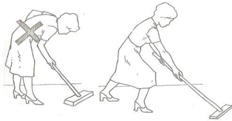
Držadla čistících pomůcek musí být dostatečně dlouhá
