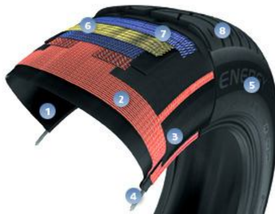
Obr. 1 Členění vrstev pneumatiky (zn. Michelin)
