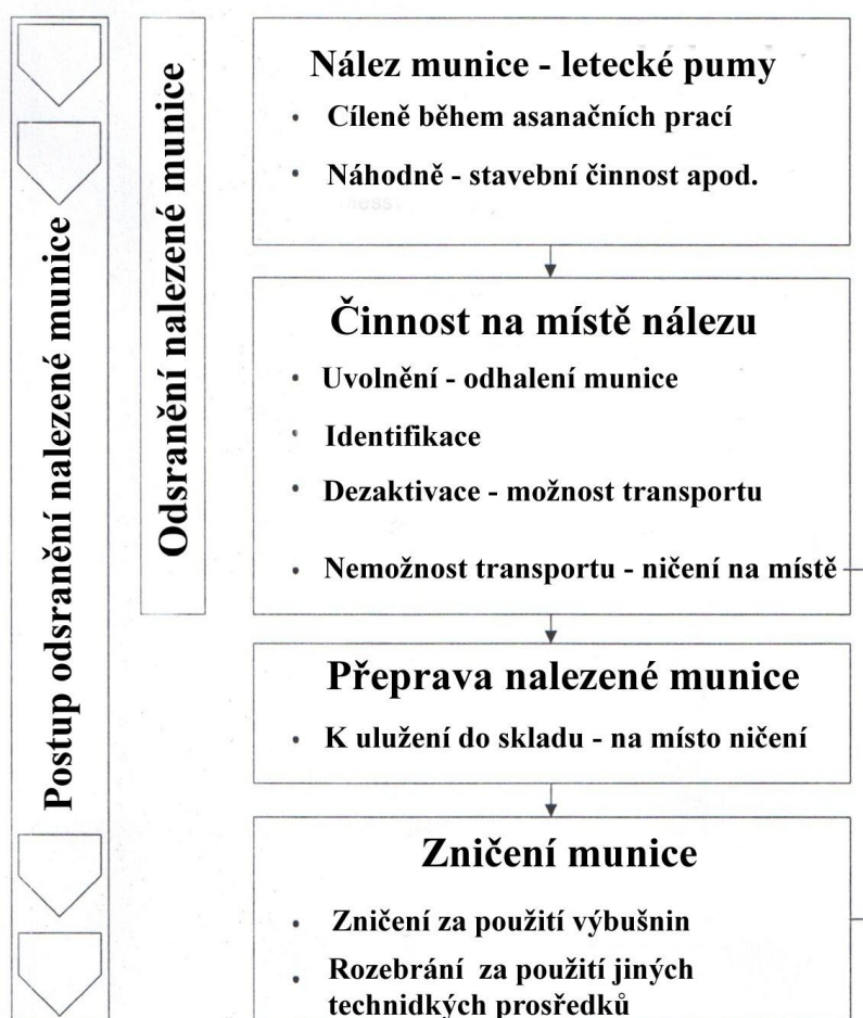
Obrázek 12. –Postup odstranění nalezené munice – letecké pumy
