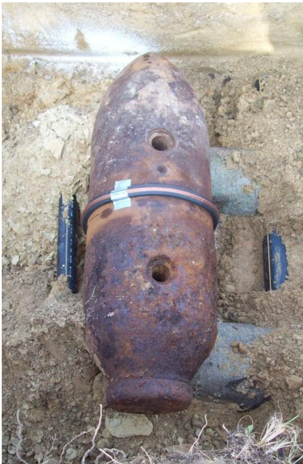
Obrázek 21. –Přiložený RAZOR 10 po obvodu letecké pumy
