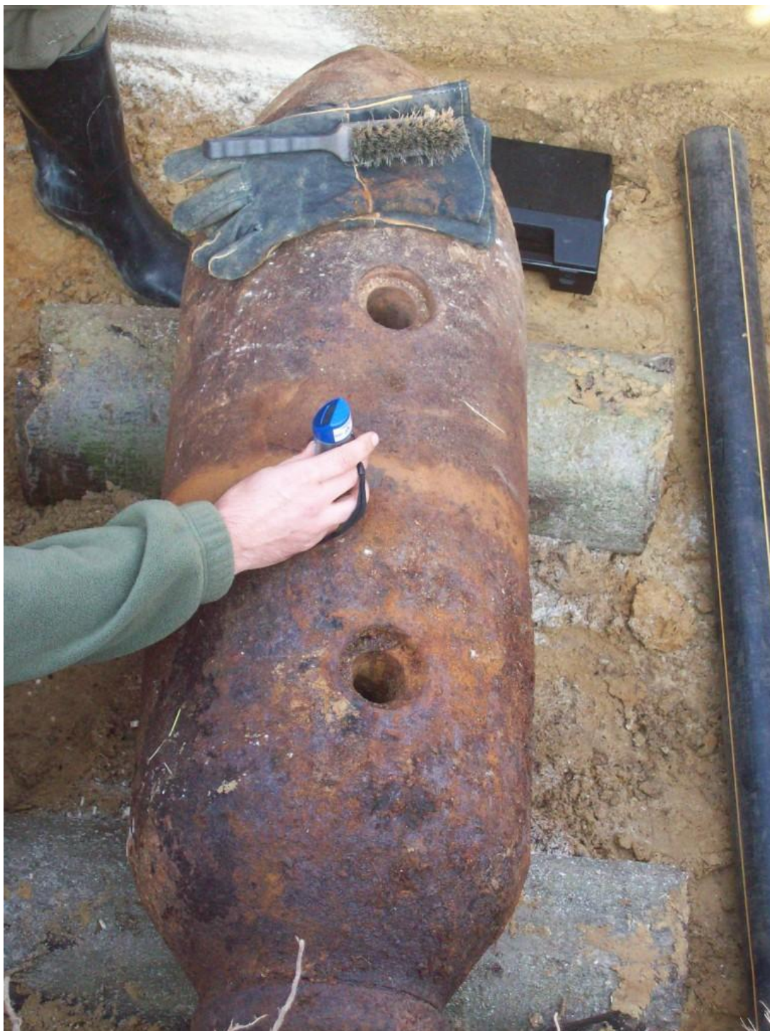
Obrázek 20. –Měření síly stěny letecké pumy SD – 250 pomocí ultrazvukového tloušťkoměru Stress Pocket Mike
