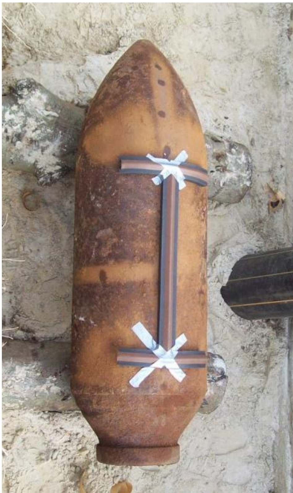
Obrázek 23. –Přiložený RAZOR 15 v podélné ose letecké pumy ve tvaru „H“
