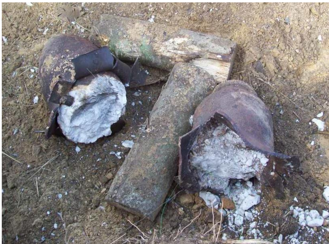
Obrázek 22. –Výsledek výbušného oddělování pomocí RAZORU 10
