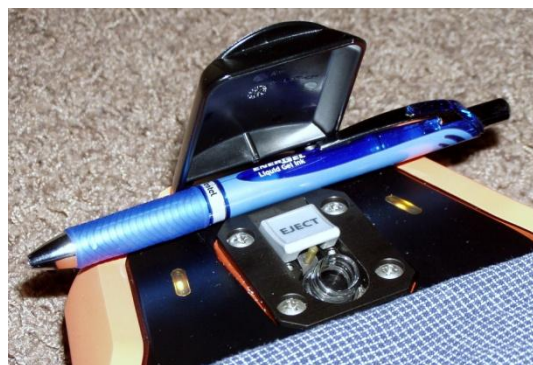
Obrázek 12: Krytí přístroje a aretace víka vialkového prostoru
