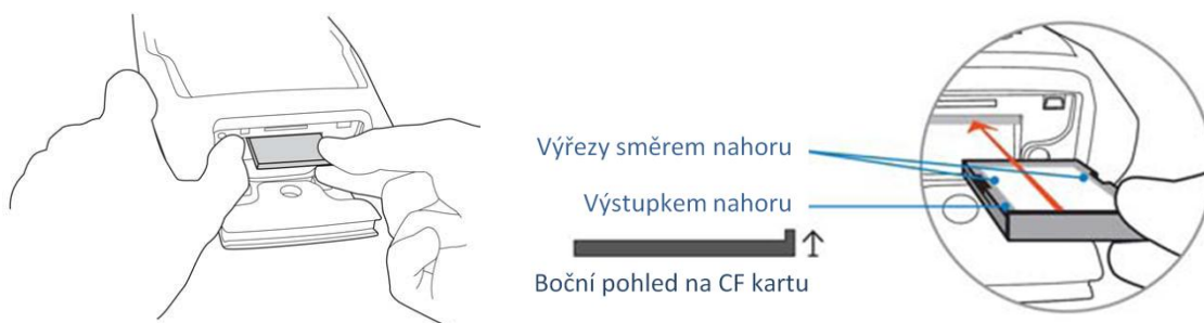
Obrázek 14: Vložení CF karty do přístroje
