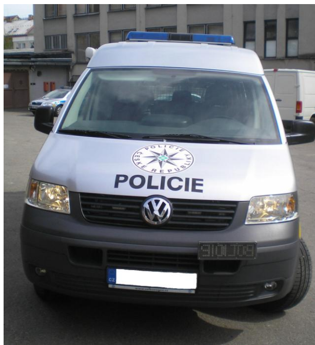
Obrázek 3: Komponent STOP/POLICIE na předním nárazníku 2 x Predátor (výstražné zařízení) umístěný v masce
