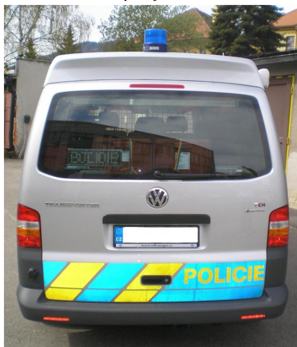
Obrázek 4: Komponent STOP/POLICIE na pátých dveřích, zadní zábleskový maják na střeše vozidla
