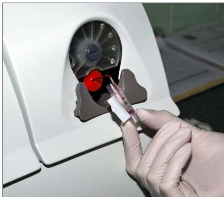
Příloha 5. Nasávání vzorku do analyzátoru Cobas b221
