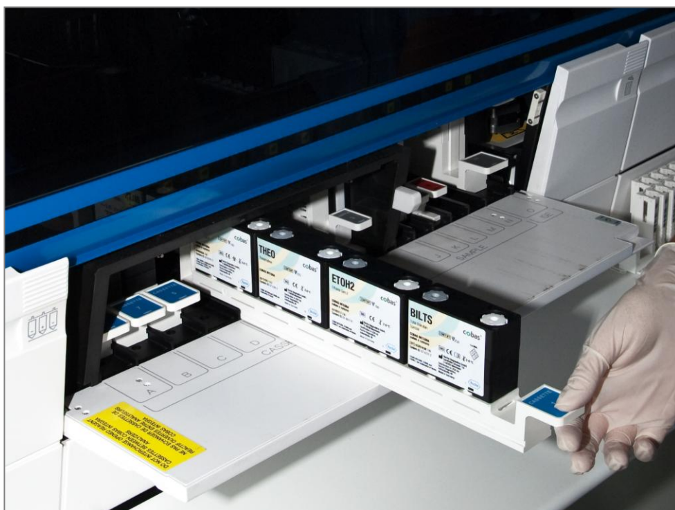
Příloha 7. Umístění reagenční kazety do analyzátoru
