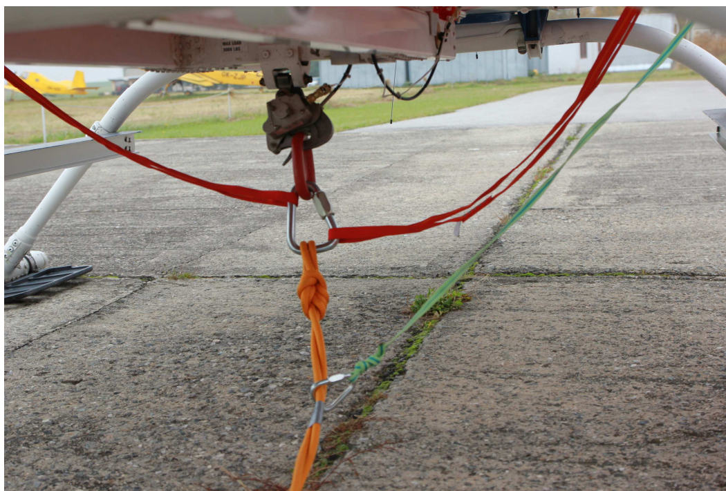
Obrázek 6. Ukotvené podvěsové lano v podvěsovém háku s připojenou zajišťovací a manipulační smyčkou
