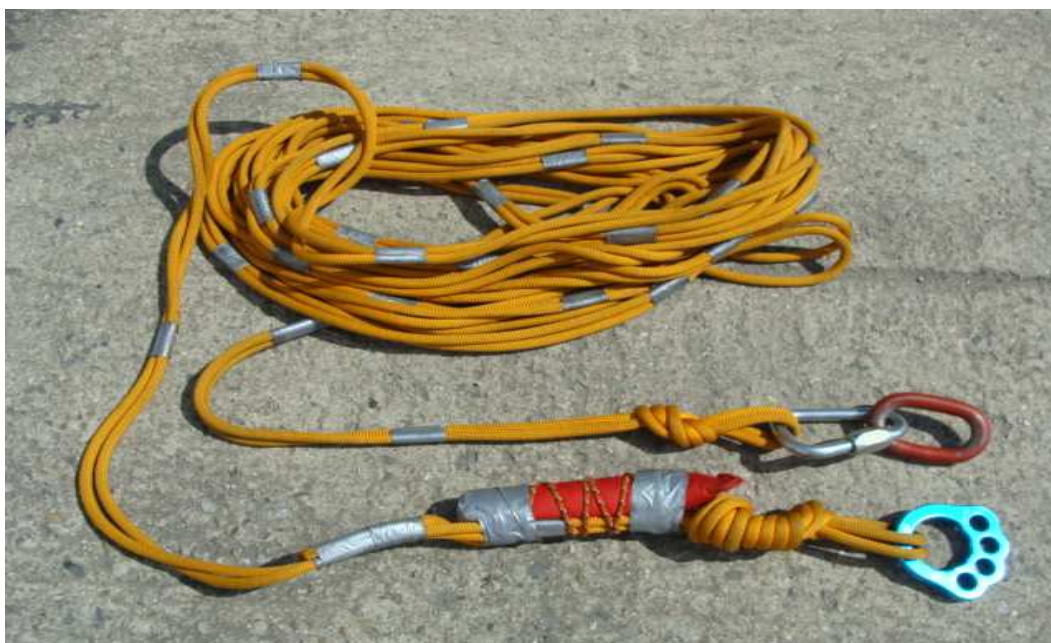
Obrázek 4. Zkompletované podvěsové lano
