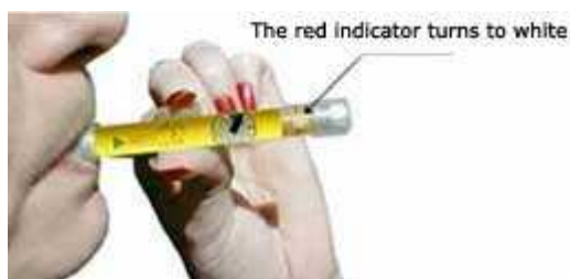
Obr. 27 Změna barvy termoindikátoru
