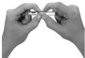
Obr. 32 Třetí krok - zmáčknutí skleněné ampule uvnitř trubičky mezi palci a ukazováčky
