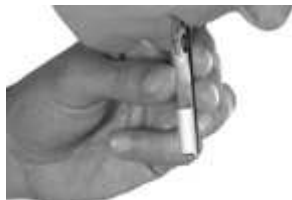
Obr. 31 Druhý krok - provedení výdechu do trubičky po směru šipky po dobu 12 sekund
