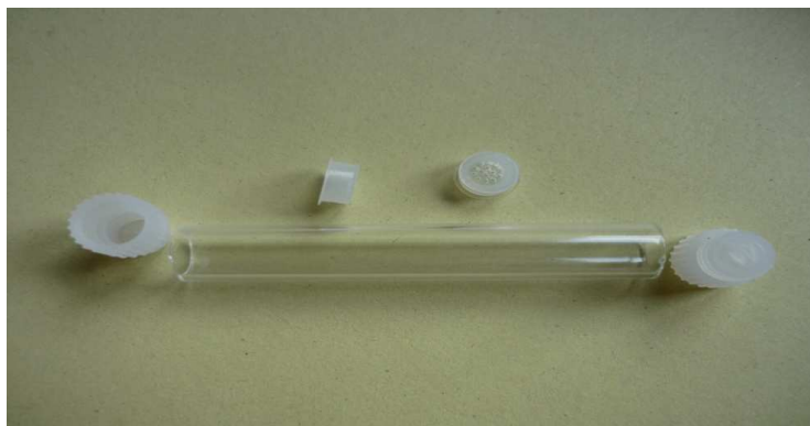
Obr. 34 Jednotlivé komponenty k detekční trubičce Tejas
