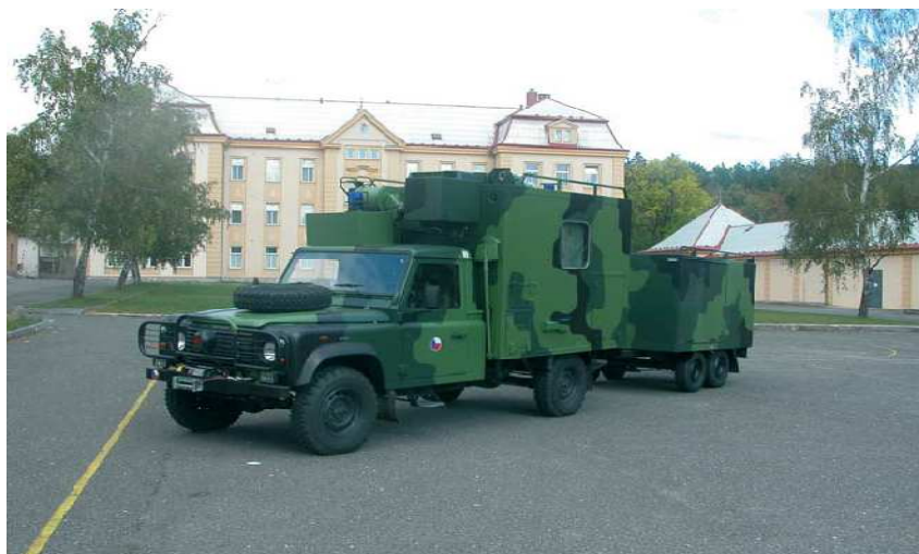
Obrázek 40 - Vozidlo radiačního a chemického průzkumu Land Rover – RCH (31)
