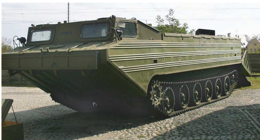
Obrázek 24 - Transportér pásový obojživelný PTS-10 (18)
