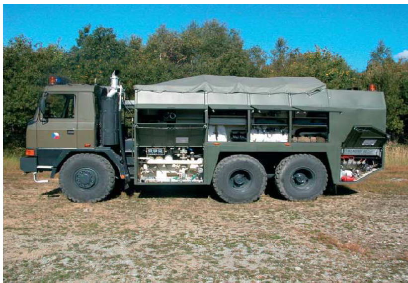
Obrázek 42 - Automobil chemický rozstříkovací ACHR – 90 M (31)
