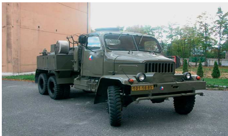
Obrázek 41 - Automobil chemický rozstříkovací ARS – 12 M (31)
