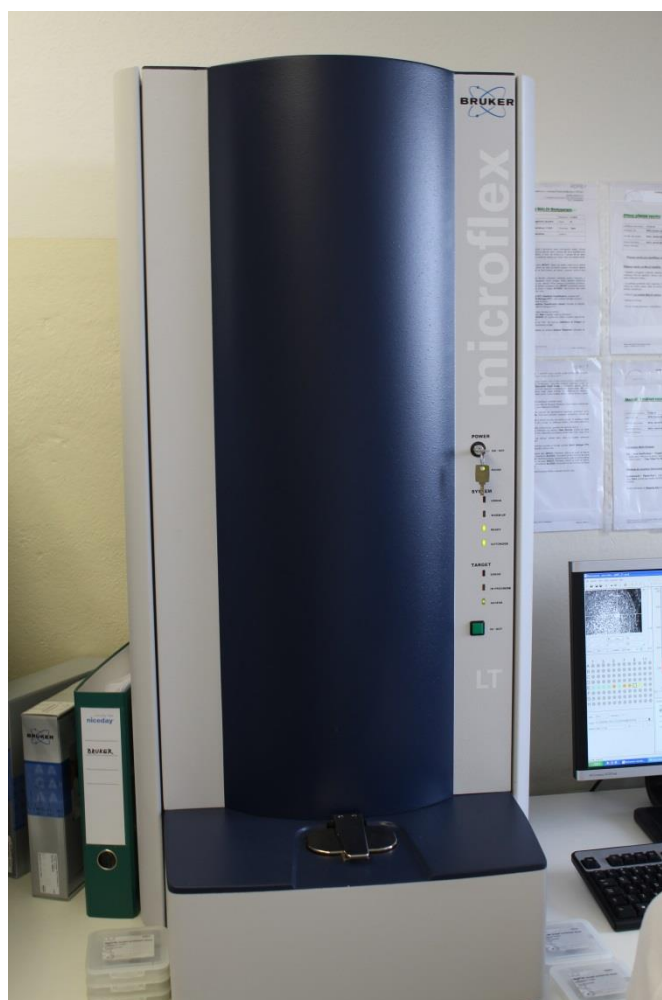
Obr. 6: MALDI TOF. Přístroj Microflex firmy Bruker. Je vysoký zhruba 1 m. Dole můžeme vidět stříbrné víčko, pod které uložíme destičku s materiálem.
