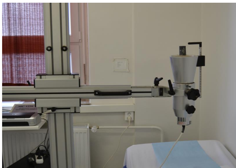
Obrázek 6: scintilační sonda s krystalem NaI(Tl)
