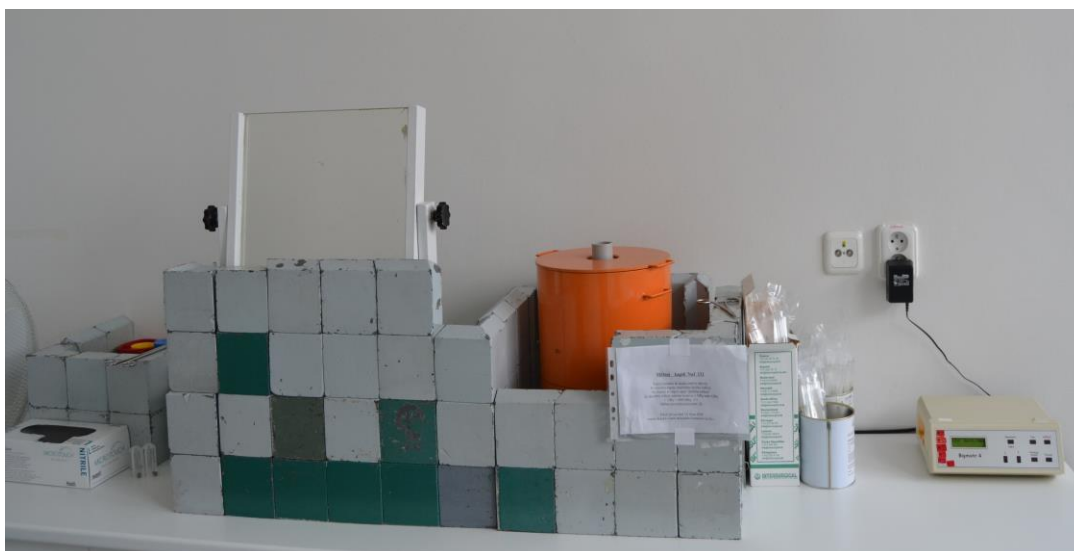
Obrázek 3: odstíněná plocha pro práci s radiofarmaky, olověná guma
