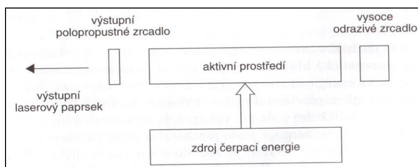
Obrázek 4. Schematické znázornění principu laseru (15)
